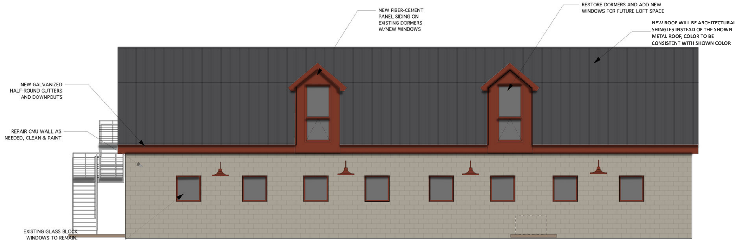
4 NORTH ELEVATION Scale: 1/8" = 1'-0"
